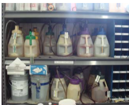
图 3 封闭式加油桶-防止二次污染
