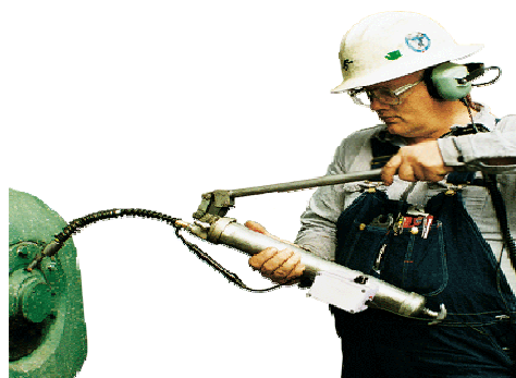
图 4 使用轴承润滑听诊仪-避免加脂过量
